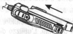
Fare scivolare la batteria sul retro del ricetrasmittitore fino a quando il blocco posto alla base della radio si aggancia e blocca la batteria.
