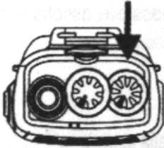
Accendere il ricetrasmittitore ruotando in senso orario la manopola Accensione/Volume fino a quando non si sente un click, il ricetrasmittitore è ora nella modalità stand-by.
