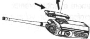
Se necessario, applicare la clip da cintura al ricetrasmittitore, facendola scivolare nell'apposita scanalatura posta sul retro della batteria fino a quando il blocco metallico si aggancia. Per rimuovere la clip premere sul blocco metallico e farla scivolare via dalla batteria.
