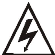
Questo simbolo indica la presenza di “tensione pericolosa” non isolata all'interno dell'apparecchio, che può comportare un rischio di scossa.
