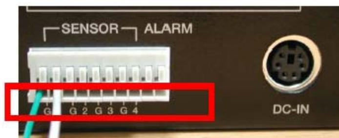
Nella figura precedente, tre sensori, per il canale 1,2 e 3 sono collegati al DVR. Ora il sensore è pronto per permettere al DVR di rilevare ogni movimento.
