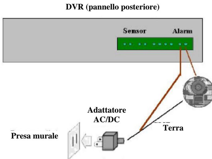
L'immagine di seguito rappresenta il terminale del commutatore dell'allarme che si trova sul pannello posteriore del DVR.
